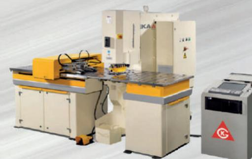
Poinçonneuse à commande numérique pour tôles épaisses.
